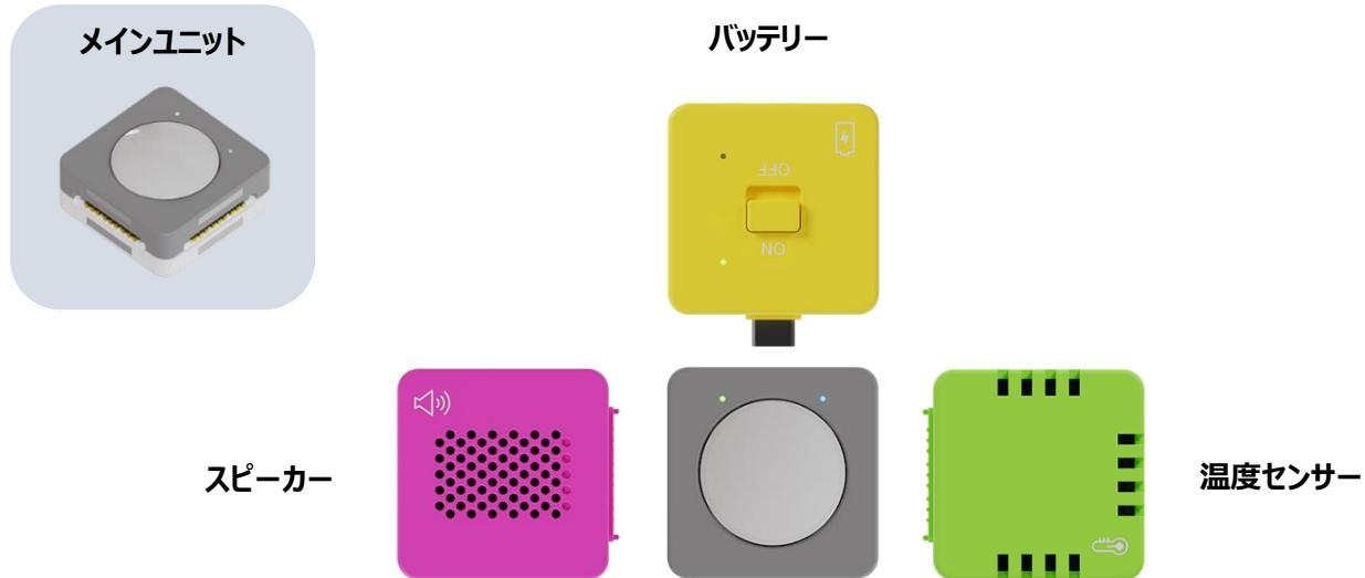
(バッテリーがない場合は、USB ケーブルを使ってデバイスや AC アダプター（5V、1~1.5A）から電気を送ってください。)
