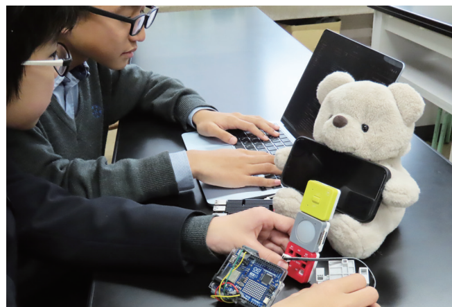
作品で使用されたぬいぐるみを動かす仕組み (ぬいぐるみの背中にサーボモーターを組み込み、左右に揺らす)
