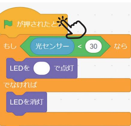
ボタンが押され瞬間に一度だけ光センサーの値を確認すると、すぐにプログラムが終了します。プログラムが終了したあとに光センサーに手を近づけたり離したりしても、プログラムは反応しません。
