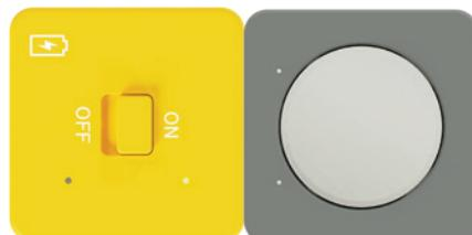
バッテリーの電源スイッチをONにするとメインユニットに電気が送られて、転送したプログラムが動きます。
