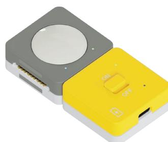
電源スイッチをONにするとバッテリーからメインユニットに電気が送られて、プログラムが動くようになります。
