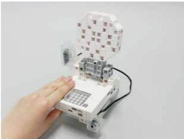
如果紅外光反射感應器被蓋住，馬桶蓋將保持打開狀態（有人坐在馬桶上）。
