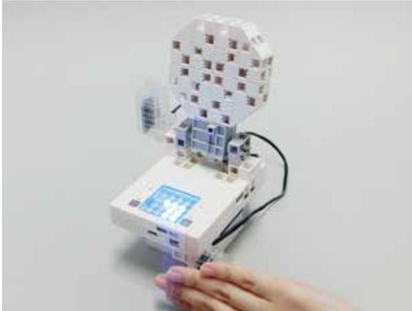
當紅外光反射感應器檢測到附近有人時，馬桶蓋將自動打開。
