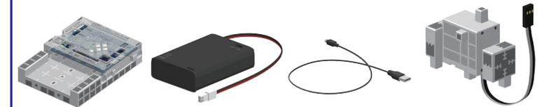
基板本体×1 電池ボックス×1 USBケーブル×1 サーボモーター×3
