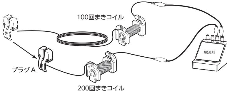
**実験** 100回まきコイルと200回まきコイルを直列につなぎ、流れる電流の大きさと付いたくぎの本数・手ごたえを調べる。
