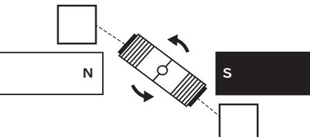
4 半回転したときに電流の向きを変えると電じしゃくのN極とS極が反対になり、ふたたび電じしゃくとじしゃくの同じ極どうしが反発しあって回転する。
