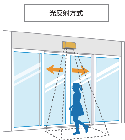
ドアの上に取り付けられたセンサーから出る 光を反射するものがあると開く
