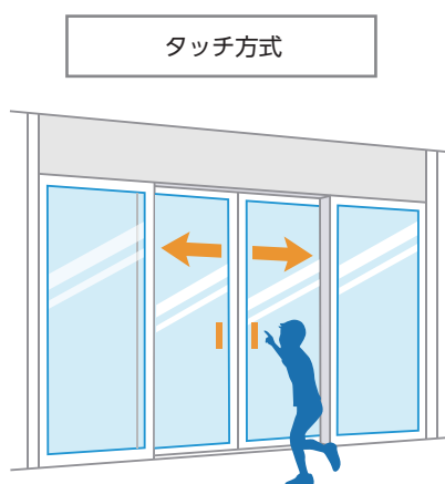
ドアに取り付けられた タッチスイッチを押すと開く
