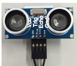
超音波距離センサー メスコネクタの金属部分が上を 向くように接続します。
