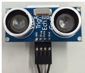
超聲波感應器 母連接器的金屬面應朝上
